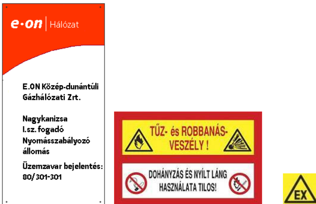
Nyomásszabályozó állomás felirati táblái I.-2.5 ábra
