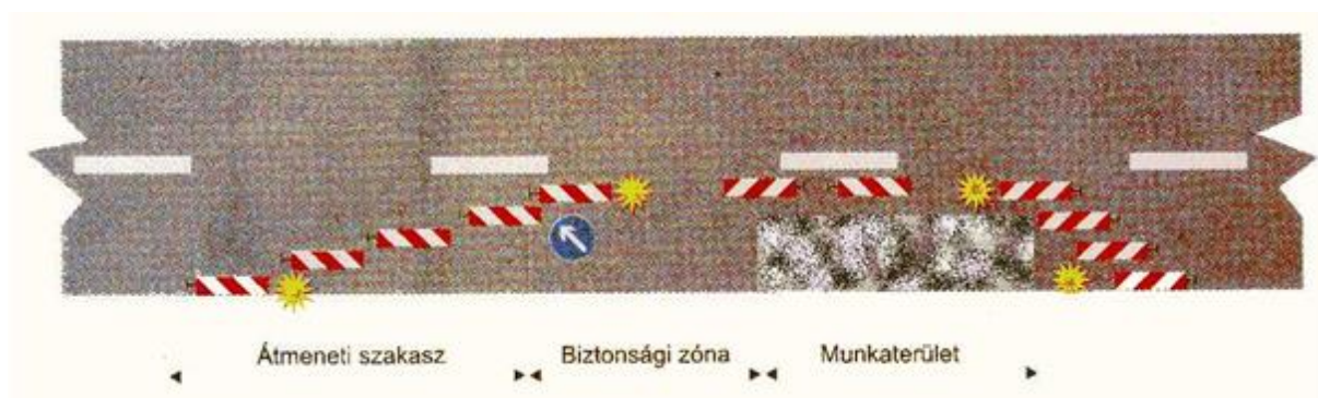
V.105 ábra Átmenettel kialakított munkaterület és biztonsági zóna
